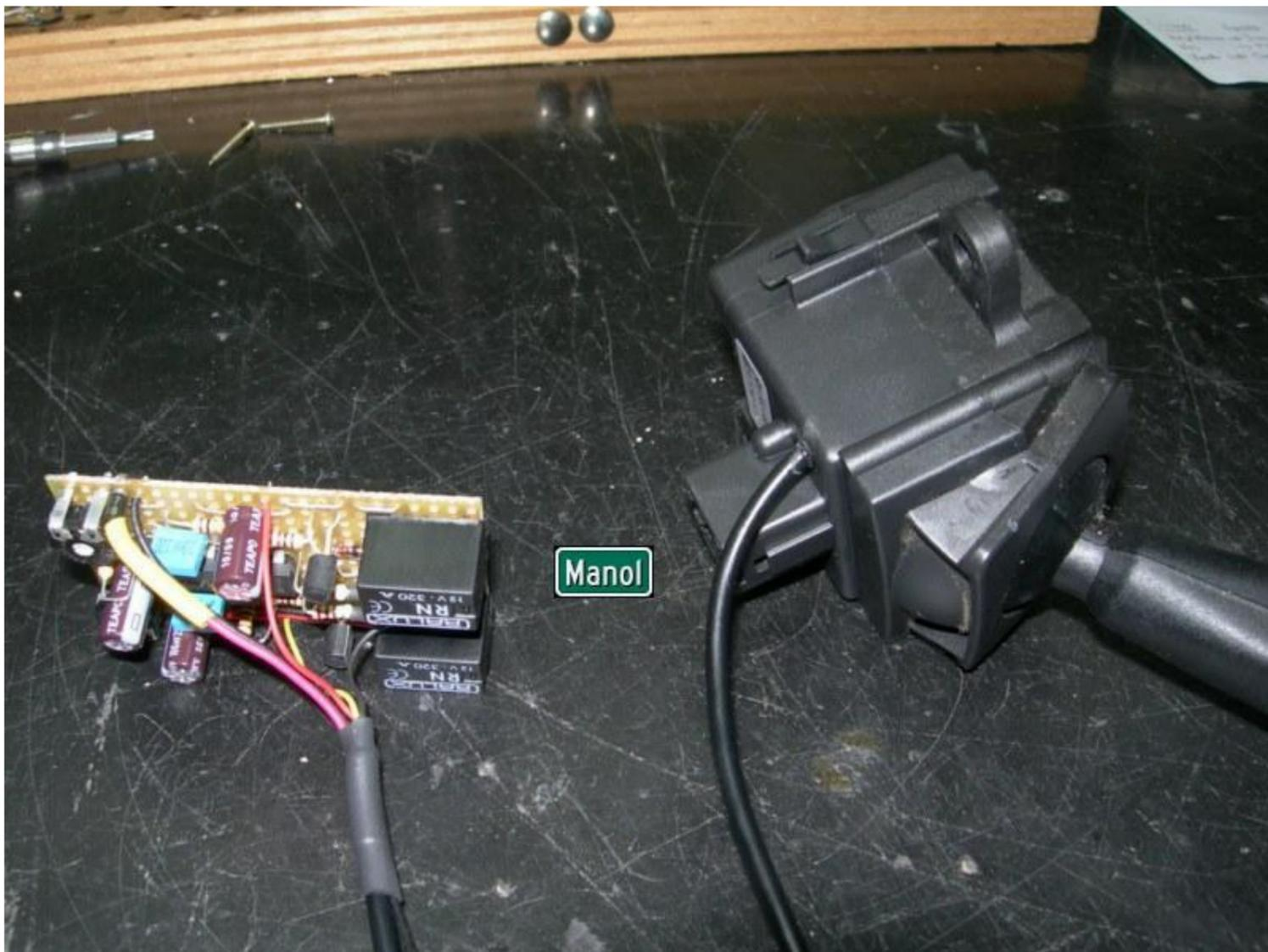
Aprovechando el soporte que lleva el coche para la palanca de ajuste del volante eléctrico, y que el mio no la lleva, he añadido un soporte al circuito:
